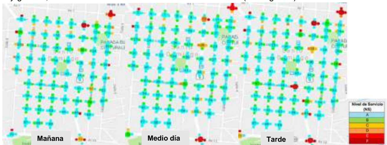
Figura 2. Niveles de servicio según periodos del día en el cantón de Santo Domingo Fuente: INTRACA, 2018, modificada por ProDUS-UCR
