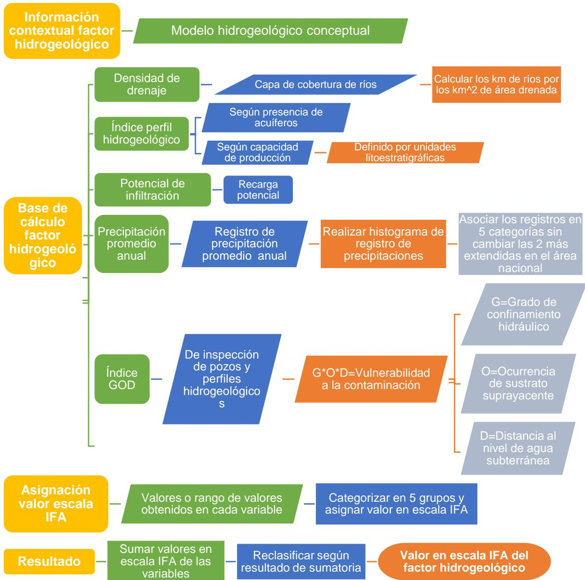
Figura 1-12. Diagrama resumen de la metodología de cálculo del factor hidrogeológico.
